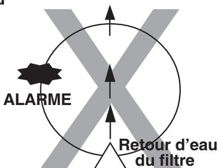
Ne pointez pas la bille du retour d'eau vers le centre avec l'alarme sur le côté. Le courant du retour d'eau perturbera, et ainsi le détecteur de l'alarme ne pourra pas détecter le mouvement de la vague correctement
