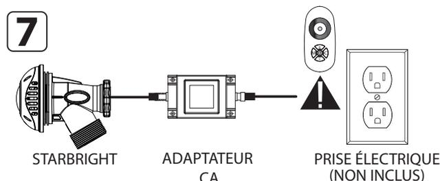
Installer l'adaptateur CA à l'endroit désiré, idéalement à l'abri des intempéries et connecter la lumière. Lisez les instructions d'utilisation avant de brancher l'adaptateur CA à votre prise de courant.
