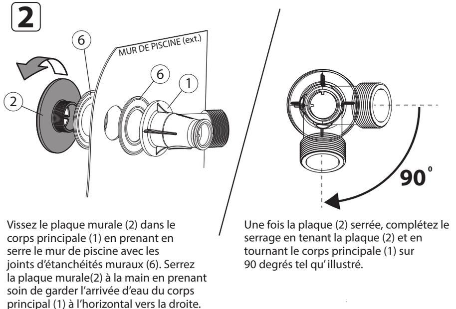
Vissez la plaque murale (2) dans le corps principale (1) en prenant en serre le mur de piscine avec les joints d'étanchéités muraux (6). Serrez la plaque murale(2) à la main en prenant soin de garder l'arrivée d'eau du corps principal (1) à l'horizontal vers la droite.
