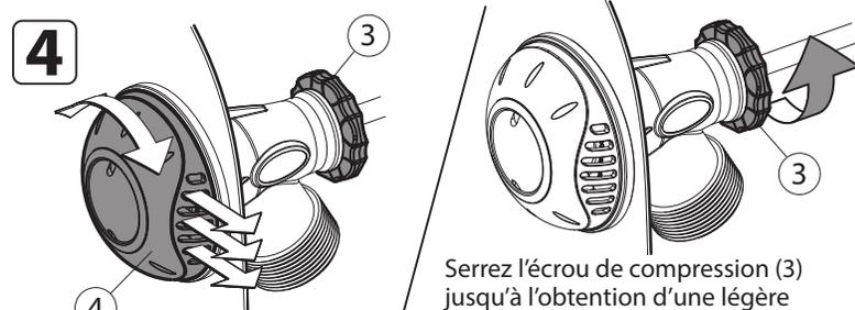
Vissez l'écrou (3) SANS LE SERRER. Orientez le DÔME (4) de façon à diriger le jet du retour d'eau.
