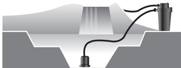
C. Au-dessus du sol, eau pompée jusqu'à la chute.
